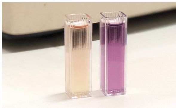
Figura 4 - Solução DPPH em meio a extrato com ação antioxidante e etanol 80% (esq.); solução DPPH em meio a etanol 80% (dir.).
