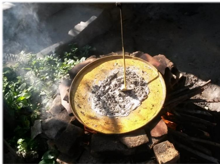
Figura 4. Fundição de chumbo metálico para obtenção do óxido de chumbo.
