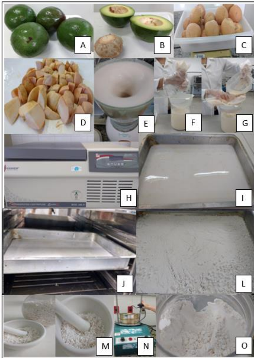
Figura 10- Esquema da extração do amido do caroço de abacate.
