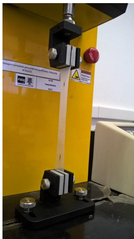
Figura 7. Avaliação das propriedades mecânicas dos filmes elaborados. Autoria própria (2017).
