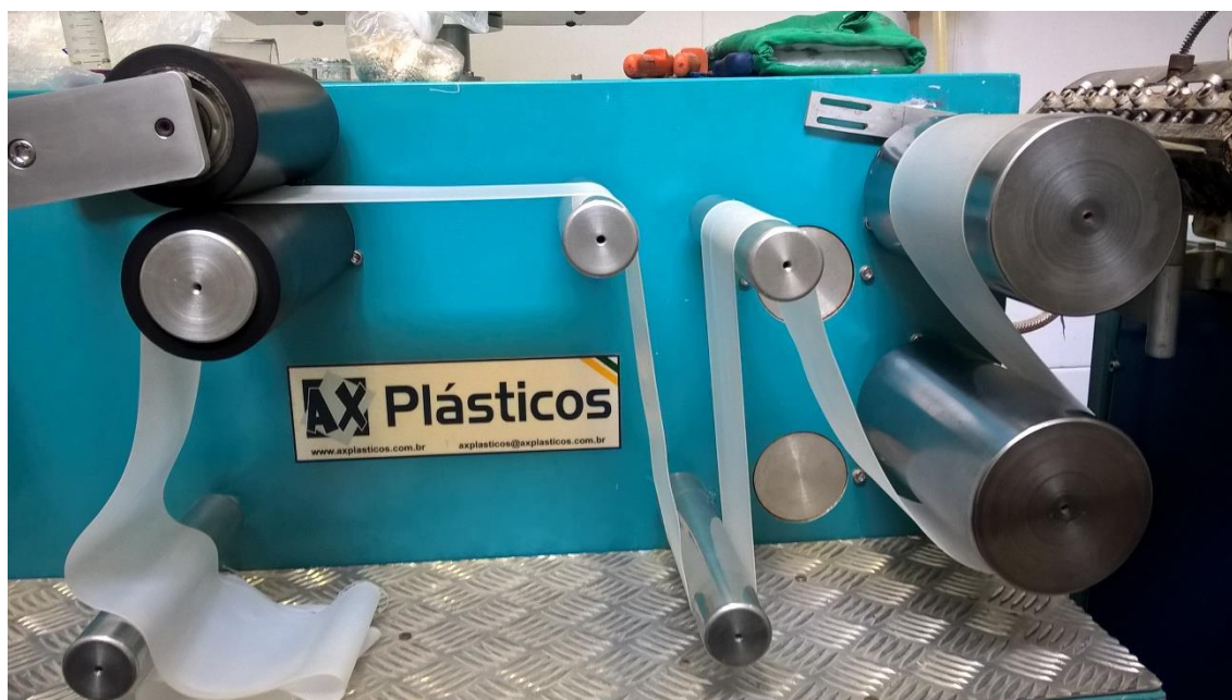
Figura 6. Processo de extrusão dos filmes amido de mandioca:PBAT:glicerol Autoria própria (2017).
