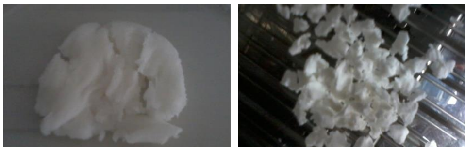
Figura 2. Polpa de celulose de coco resultante do branqueamento (A) antes e (B) após secagem em estufa. Autoria própria (2016).
