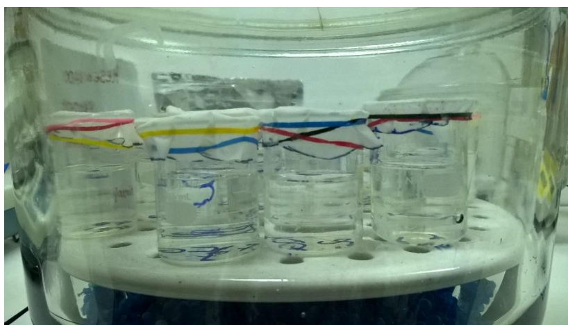
Figura 8. Caracterização das propriedades de barreira dos filmes obtidos. Autoria própria (2017).
