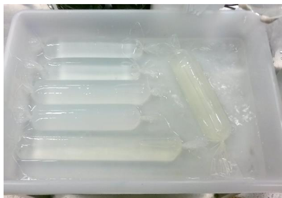
Figura 3. Diálise das soluções de nanocristais de celulose da fibra do coco. Autoria própria (2016).
