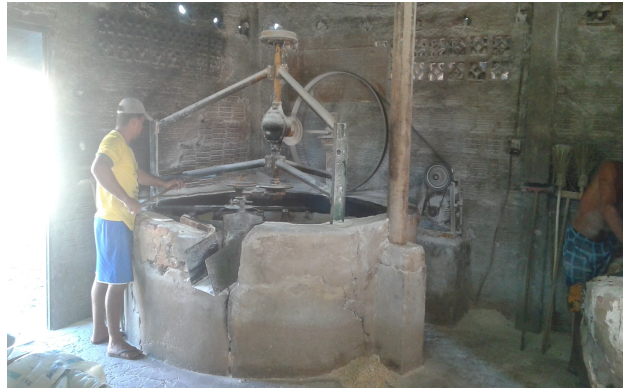
c). Forno com mexedura mecanizada.
