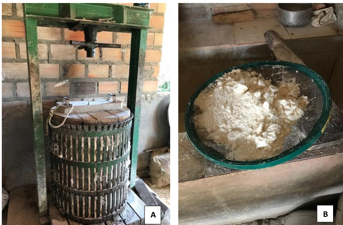
Figura 6: Prensa para a massa de mandioca triturada (A) e peneiragem da massa prensada e esfarelada (B).
