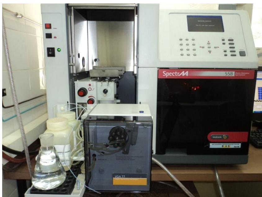
Figura 11. Espectrômetro de absorção atômica (Varian, Spectr AA 55B, Mulgrave Victoria, AU), acoplado ao Vapor Frio.
